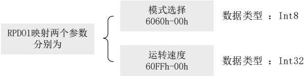
图 3-12 PDO1 映射关系举例
