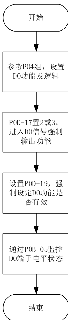
图 5-11 D0 信号强制输出设定步骤示意图
