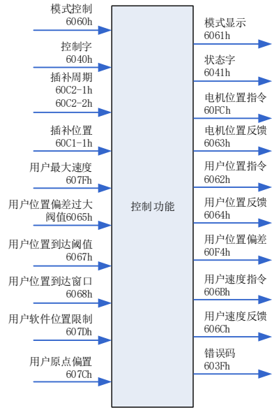
图 9-46 插补模式下输入输出框图
